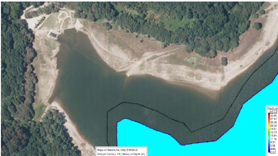
Figura 12. Mapa de calados máximos obtido con Iber+ para o evento de inundación rexistrado o 22/04/2019 considerando unha barreira de protección nas inmediacións do xacemento. PNOA cedido polo Instituto Xeográfico Nacional de España
